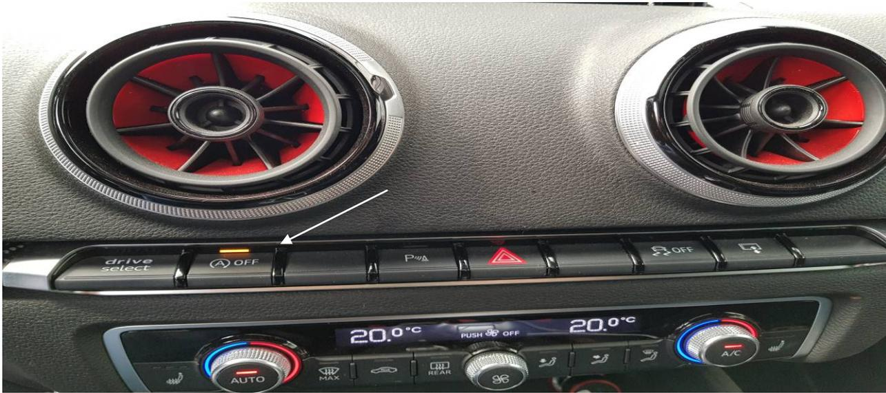
Mit Hilfe der **SSA-Taste (A-OFF)**, können Sie die Klappensteuerung vollständig deaktivieren. Dieser Zustand wird gespeichert und solange beibehalten, bis Sie das Modul wieder aktivieren.
