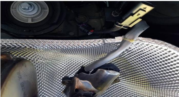
Wir empfehlen die Leitungen Außen über dem Hitzeschutzblech zu verlegen, um diese vor Hitze der Abgasanlage zu schützen.
