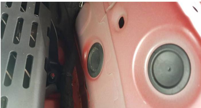
Wenn Sie die Leitung dort entlang nach außen geführt haben, schneiden Sie die Tülle entsprechend an, damit die Leitung hindurch kann und das Loch wieder verschlossen wird.
