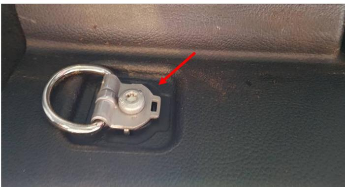
Die Einstiegsleiste ist lediglich geclipst, aber bevor Sie die Abdeckung ausclippen können, müssen die beiden Schrauben der Halter entfernt werden und die Zentrale Schraube mittig.
