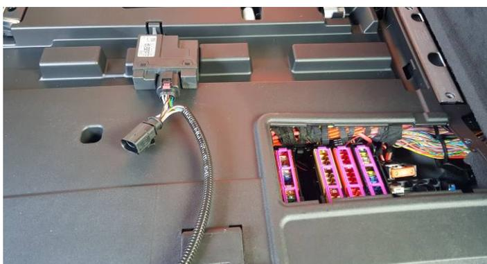
Bei Verbau vom Active Sound Gateway, wird es lediglich zwischen den Original Stecker und dem Audi Steuergerät angeschlossen.
