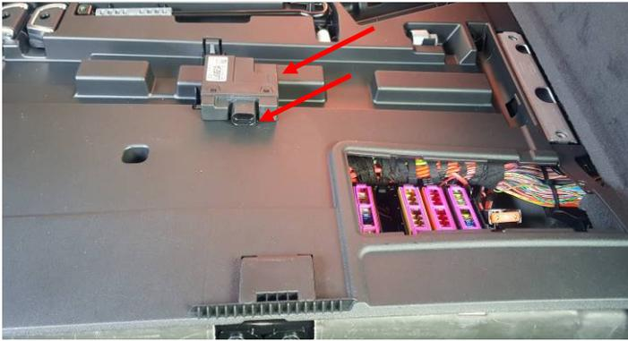
Das Steuergerät befindet sich unter der Abdeckung an der gezeigten Position auf dem Bild.
