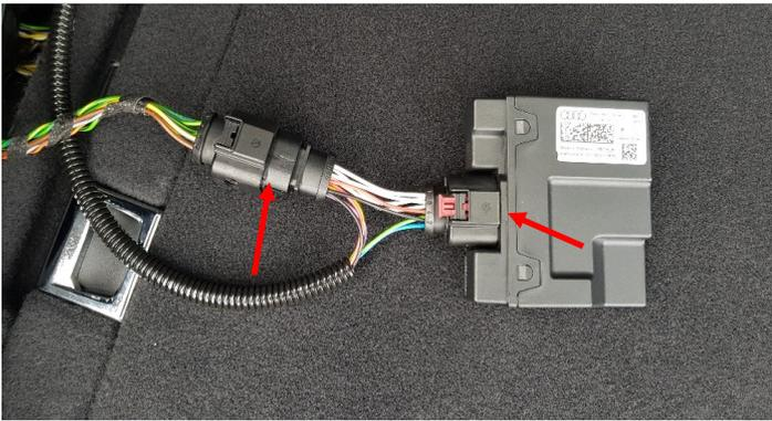
Unser Active Sound Gateway wird lediglich zwischen das Steuergerät und dem original Kabelbaum Plug&Play zwischengesteckt.
