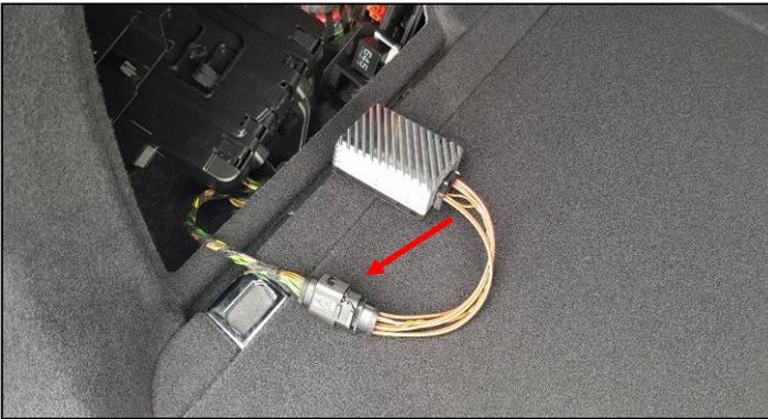
Unsere Active Sound Unit wird anstelle des original Audi Steuergerätes, Plug&Play an den Kabelbaum angeschlossen und ersetzt das Audi Steuergerät.
